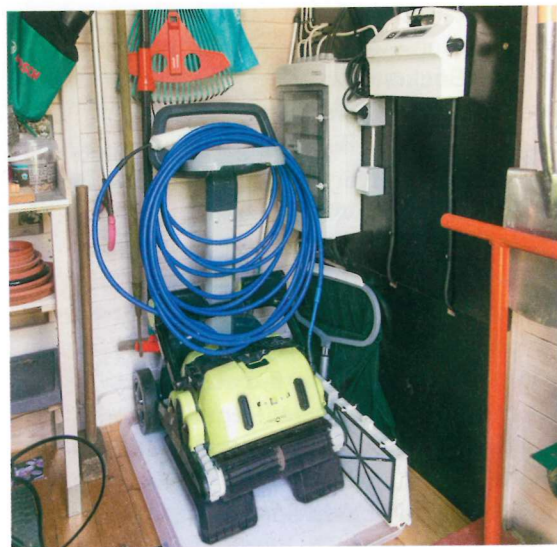
Schwimmroboter entfernen rutschigen Biofilm von Wänden und Böden.
